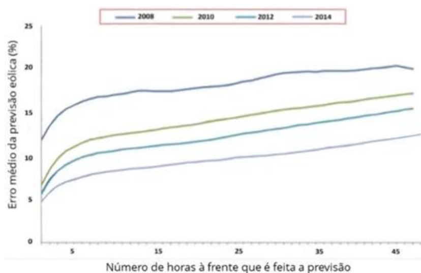
Figura 7 – Erro médio das previsões dos geradores eólicos no mercado espanhol, em função do número de horas à frente e ao longo dos anos
