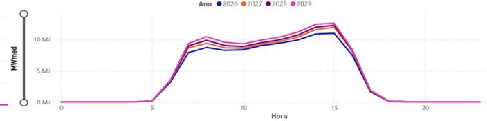
Nota-se, através da alteração no formato da curva, em relação ao esperado, e para ambos os perfis de dia considerados, a expectativa de continuidade na ocorrência de cortes nas gerações eólica e fotovoltaica, com mais profundidade no perfil de domingos e feriados.
