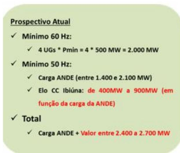
Ressalta-se que os valores mínimos no sistema de 50 Hz são definidos para manter a regulação de frequência deste sistema, enquanto os valores mínimos no sistema 60 Hz são definidos de modo a evitar o risco de autoexcitação da usina.
